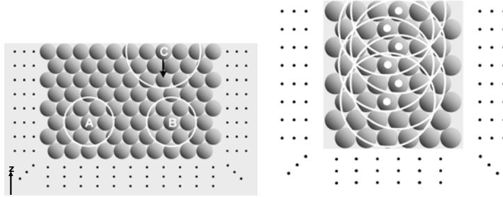
FIGURE 2.6 – Arrangement infini de type Hexaédral Face Centrée.
