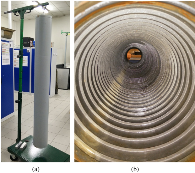
FIGURE 1 – Photos du cylindre raidi axisymétrique : (a) accroché à une potence et (b) vue intérieure.
