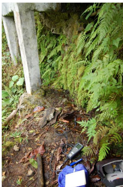
Photo 7 : Mesure des paramètres physico-chimiques du captage de Njambo, village d'Outsa avec la sonde multi paramètres.
