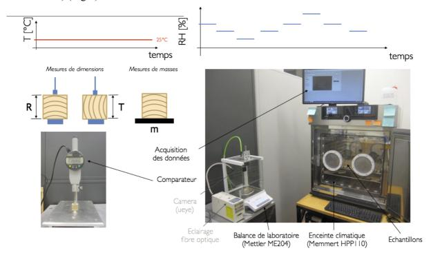
Fig. 2 : Protocole de mesures des propriétés hydriques d'échantillons de bois : réalisation de paliers d'humidité sous température constante dans une enceinte climatique, mesures dimensionnelles avec un comparateur et le dispositif d'imagerie et mesures de masse avec une balance de laboratoire.
