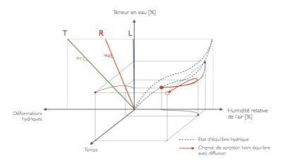
Fig. 1 : Illustration schématique d'un chemin d'adsorption dans une isotherme de sorption incluant la diffusion au cours du temps et les variations dimensionelles relative à la teneur en
