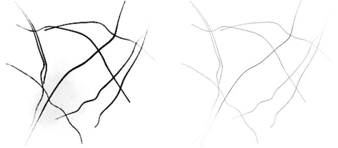
**FIGURE 1** – Gauche : image basse résolution (variance du profil temporel de chaque pixel) affichée pour la taille originale des pixels (150nm), Droite : image super-résolue obtenue (10 millions d'itérations) affichée pour une taille de pixel de 15nm.
