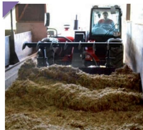
**Curage de la litière : la largeur de la case doit être suffisante pour manœuvrer facilement.**
