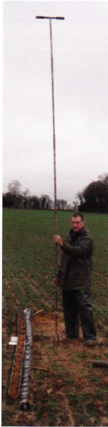
Sondage à la tarière dans un sol profond
