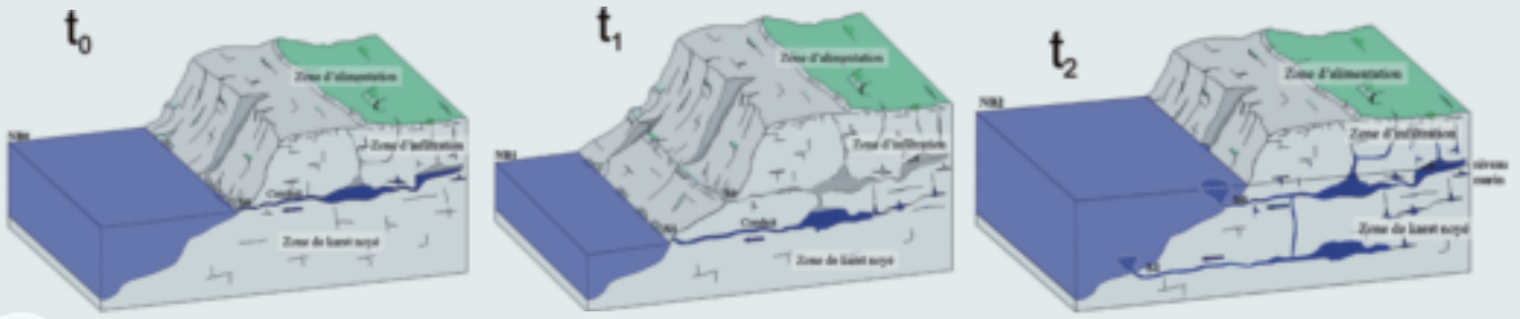
Figure 1 - Évolution du réseau karstique d'un aquifère littoral soumis aux variations eustatiques [3]. Avec la chute du niveau marin ( t_1 ), la source S_0 est abandonnée au profit de S_1 . Lors des crues, S_0 peut encore fonctionner en trop-plein. Après la remontée du niveau marin ( t_2 ), les réseaux supérieurs sont réactivés. Les réseaux inférieurs sont ennoyés et évoluent de plusieurs manières : 1/ abandon si le karst est colmaté par les sédiments marins ; 2/ maintien des écoulements profonds, remontant vers une source vauchusienne située à terre ; 3/ si le karst n'est pas colmaté, les sources basses deviennent sous-marines ou forment des estavelles.
