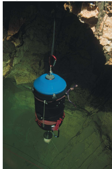
Photo 2 : La balise électromagnétique dans la rivière souterraine de Bestouan (Photo Hervé Chauvez)
