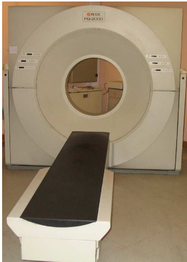
FIG. 1.7 – Appareil scanner dédié à la radiothérapie utilisé pour l'acquisition des images TDM 3D.
