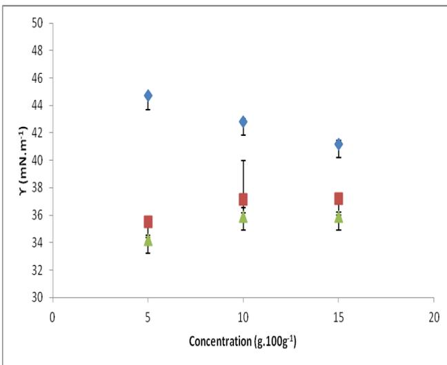
**Figure 12:** Tension de surface à l'interface air/eau, mesurer à 40 °C avec une cinétique de 600 sec en fonction la concentration de PPCN/PS (50-50) (◆), PPCN/PS (50-50) 0,5% PL (p/p) (■), PPCN/PS (50-50) 1% PL (p/p) (▲).
