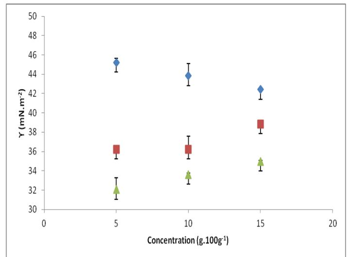
**Figure 131:** Tension de surface à l'interface air/eau, mesurer à 40 °C avec une cinétique de 600 sec en fonction la concentration de PPCN/PS (80-20) en absence et présence des PL. Symboles: PPCN/PS (80-20) (◆), PPCN/PS (80-20) 0,5% PL (p/p) (■), PPCN/PS (80-20) 1% PL (p/p) (▲).
