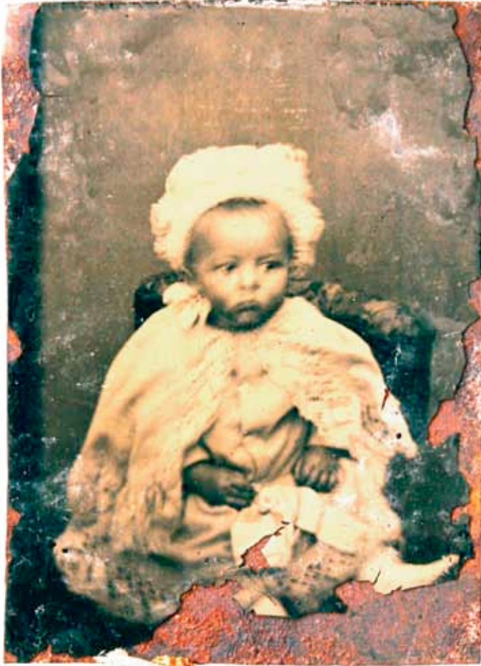
Hình 29 Ảnh kẽm khuôn khổ 1/16 tấm phiến, nhiếp ảnh gia không rõ, khoảng 1880. Sự ăn mòn của sắt đã khiến lớp hình ảnh bị bong ra.
