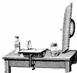
Hình 16 Thiết bị để mài nhẵn các tấm phim in kiểu Daguerre.
