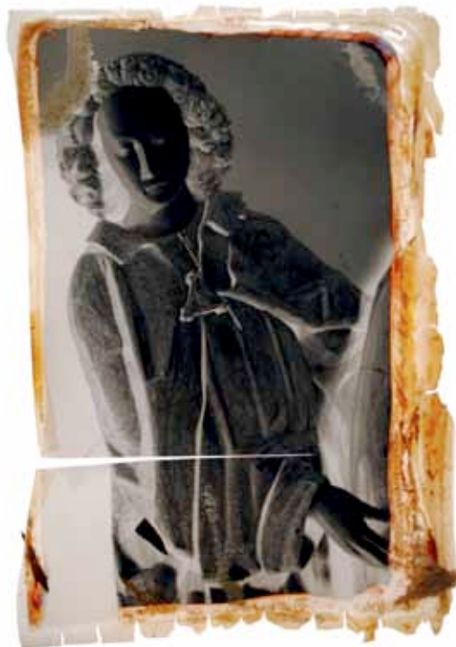
Hình 208 Âm bản phim tờ nitrat cellulose trong một tình trạng suy thoái, nhiếp ảnh gia không rõ, khoảng 1950.
