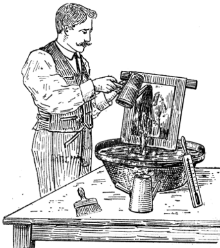
Hình 133 Việc rửa đi những phần không đông cứng của hình ảnh in than, hình chạm khắc, khoảng 1900.
