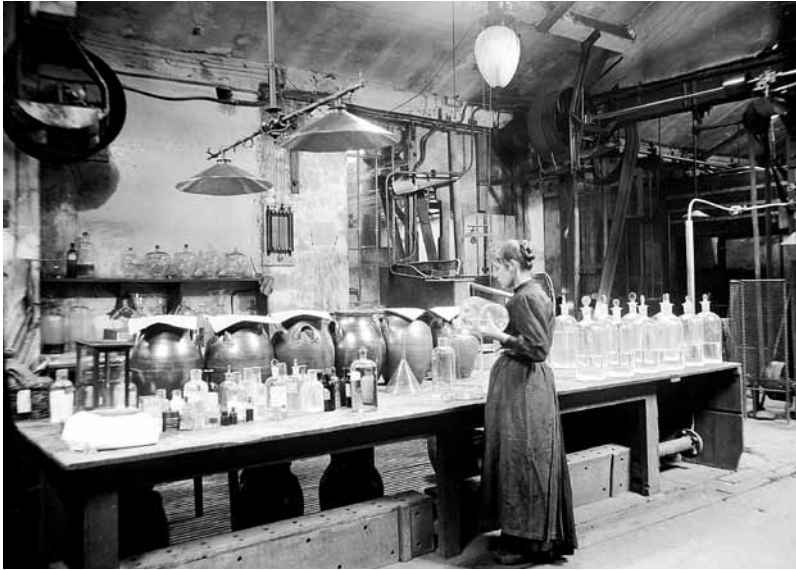
Hình 186 Những bình ủ cho việc chuẩn bị những nhũ tương bromua keo mù bạc ở Xưởng Lumière, nhiếp ảnh gia không rõ, khoảng 1900.
