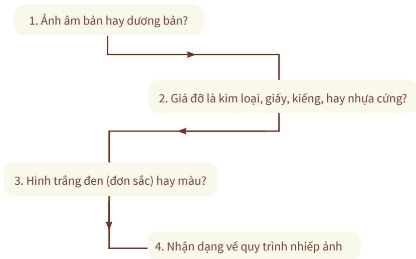
Hình 1 Sơ đồ lưu động để nhận dạng và phân loại các quá trình nhiếp ảnh được quy chiếu trong sách này.
