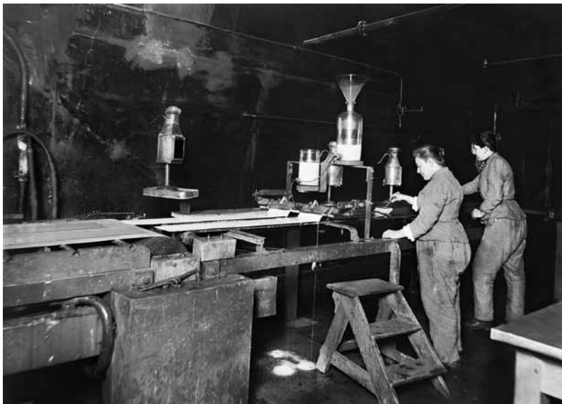
Hình 187 Máy tráng cho việc chuẩn bị những tấm phim bromua keo mù bạc, ở Xưởng Lumière, nhiếp ảnh gia không rõ, khoảng 1900.
