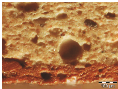
Fig. 9. — Image au microscope optique, en lumière naturelle, d'un engobe (BDX 9311), agrandissement x 200 (cliché CRPAA).
