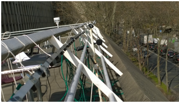
FIGURE 7 – Photo de l’antenne de 128 microphones en ligne et des autres dispositifs de mesure utilisés pour la série de mesure dans la ville.
