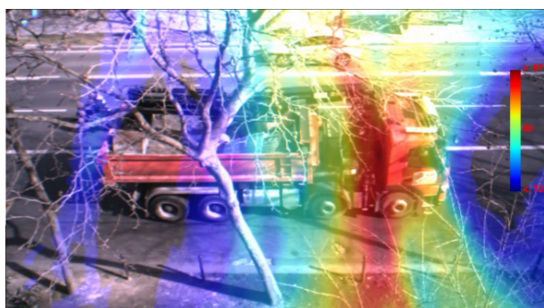
FIGURE 8 – Formation de voie d'un camion au démarrage sur la bande d'octave de 1000 Hz - Quai Saint Bernard à Paris - 15 dB de dynamique.
