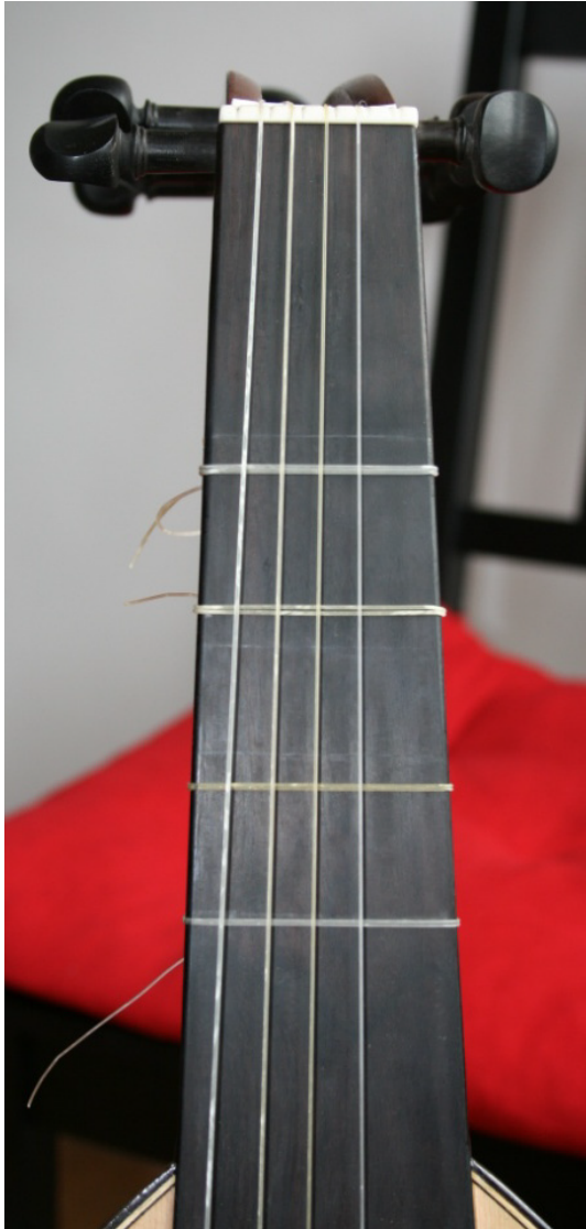
Figure 34 : « maillage pythagoricien de Ṭaḥḥān » ; les marques au crayon sur la touche montrent les emplacements des ligatures pour le maillage « harmonique » – les ligatures sont bien collées au manche et ont été montées plus facilement que pour le « maillage de Kindī »
