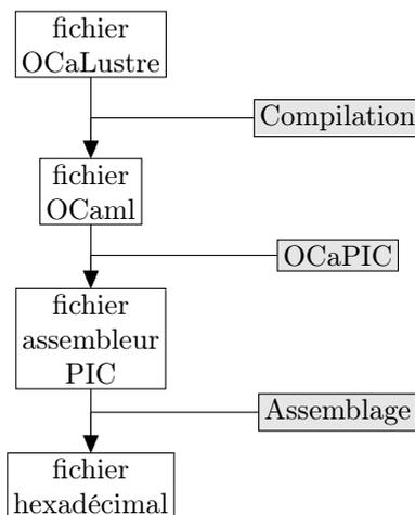
FIGURE 2 – Chaîne de compilation d'OCaLustre pour microcontrôleurs PIC
