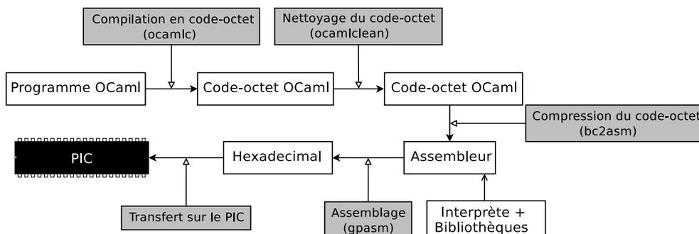
FIGURE 1 – Compilation d'un programme OCaml sur PIC
