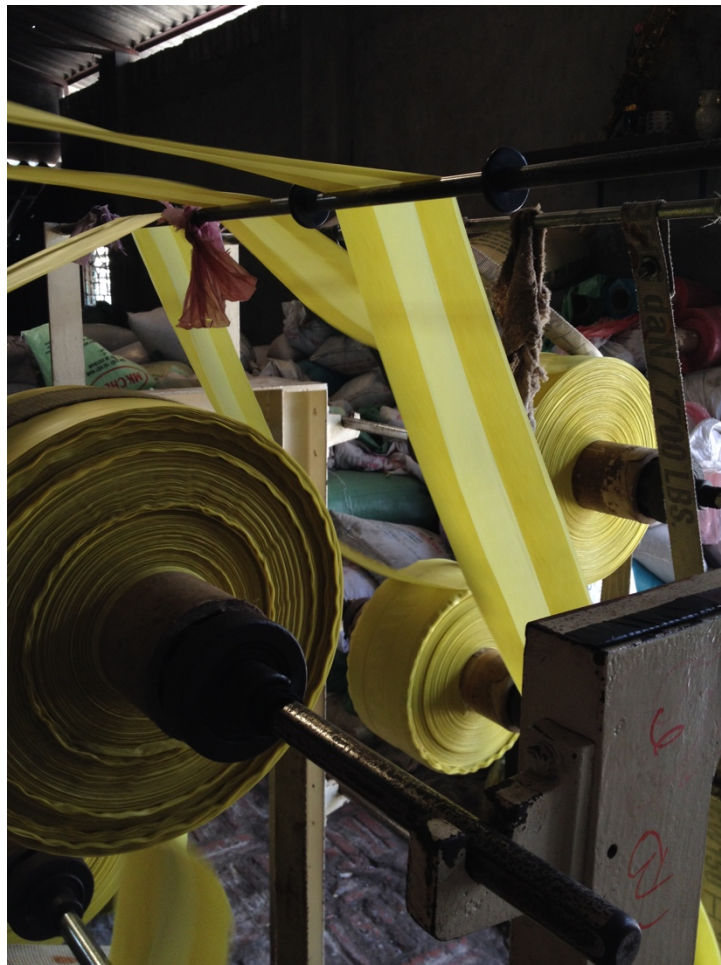
Les bobines de film plastique issu de l'extrudeuse de gonflage sont disposées sur un métier. Parfois, le film se froisse, bloquant totalement la machine.
