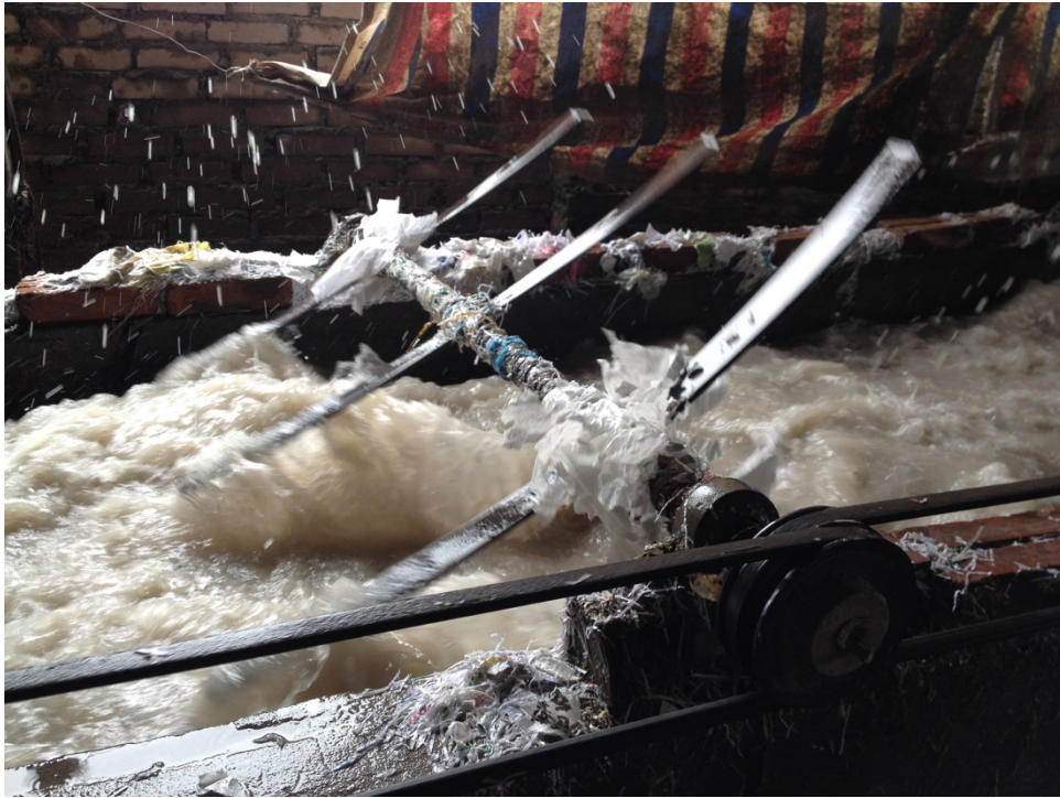
L'étape du bain de décrassage vise à nettoyer les films plastiques sales pour purifier le matériau avant transformation.
