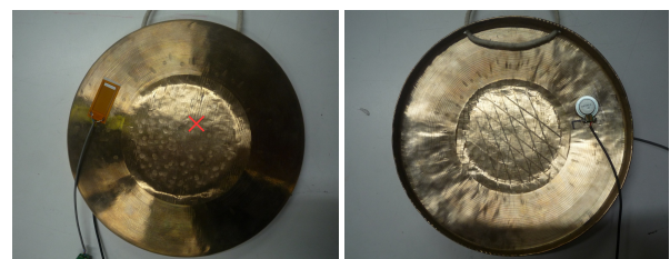
FIGURE 4 – Photographies du gong instrumenté. A gauche : Localisation du capteur MFC sur le gong et position de frappe de la mailloche (croix rouge). A droite : position de l'actionneur sur le gong, colocalisé avec le capteur.
