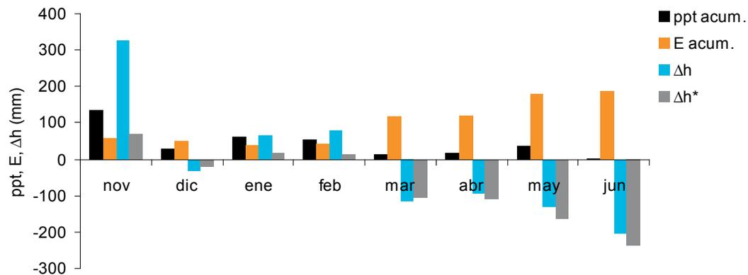
**Figura 5** | Componentes mensuales del balance simplificado de agua en Doñana: precipitación acumulada (*ppt acum.*), evaporación acumulada (*E acum.*), variación observada de nivel ( $\Delta h$ ) y variación estimada de nivel ( $\Delta h^*$ ). Datos de la estación D04, año hidrológico 2006/2007.
