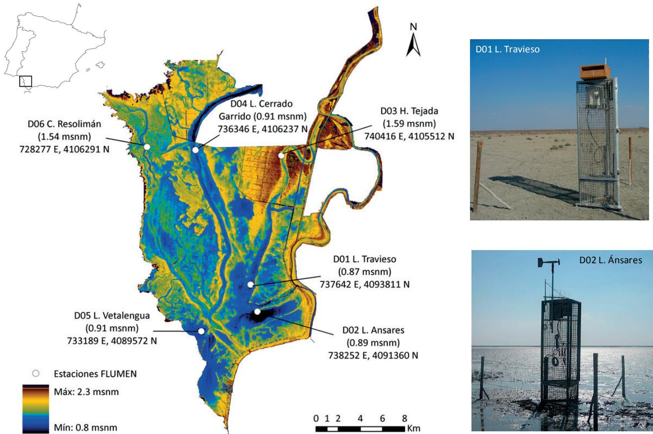
**Figura 1** | Izquierda: localización de las estaciones de medida sobre el modelo digital del terreno de la marisma de Doñana, en metros sobre el nivel del mar (msnm). Derecha: fotografías de dos estaciones de la red.
