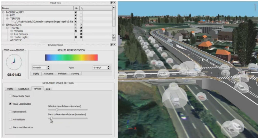
Figure 21: Interfaçage trafic / maquette numérique urbaine à différentes échelles de représentation (logiciel eveCity + SYMUVIA)
