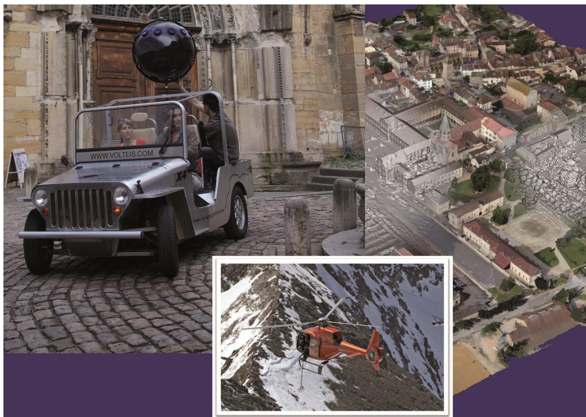
Figure 2: Exemple de la mise en œuvre terrestre ou aérienne de la sphère et des résultats obtenus sur Cluny
