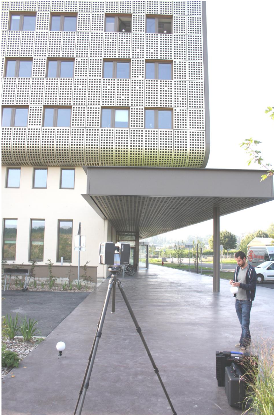
Figure 3: Acquisition avec le scanner laser FARO Focus 120 au pied du b timent Coriolis (nouveaux locaux du laboratoire IMAGINE)   Champs sur Marne
