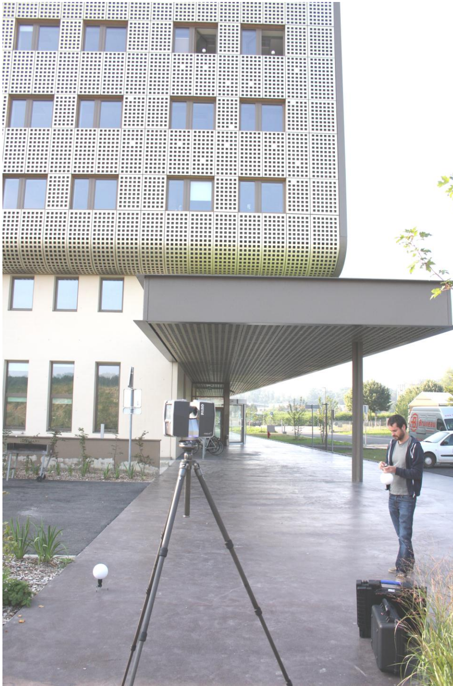
Figure 3: Acquisition avec le scanner laser FARO Focus 120 au pied du bâtiment Coriolis (nouveaux locaux du laboratoire IMAGINE) à Champs sur Marne
