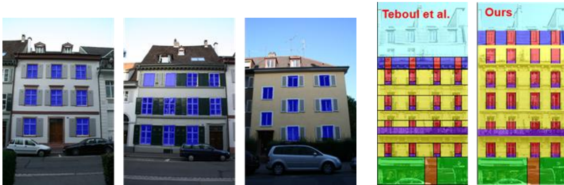
Figure 7: En 2D : amélioration de la détection de fenêtres : affranchissement des contraintes de rectification d'image et de régularité de la façade (à gauche) et analyse sémantique des images de façades par approche grammair (à droite)
