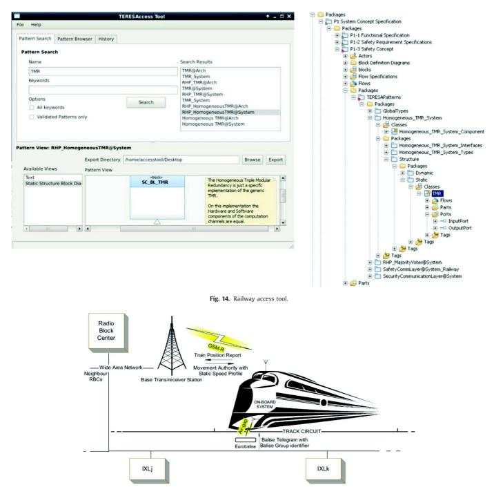
Fig. 15. ERTMS/ETCS diagram.
