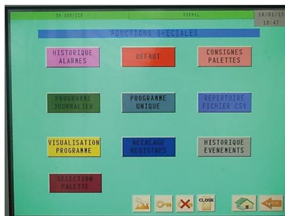
Figure 7. PC tactile de gestion (photo : C. Buré).
