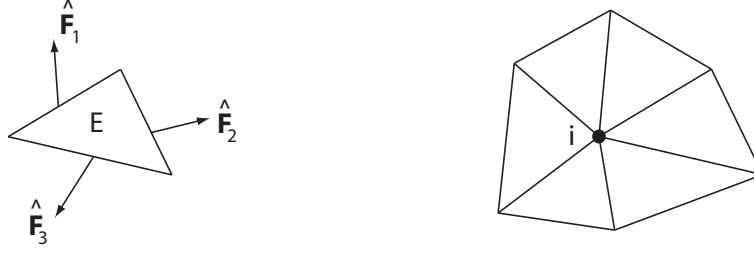
Figure 1 – Densités définies sur les bords de l'élément E (gauche), et patch d'éléments autour du nœud sommet i (droite).
