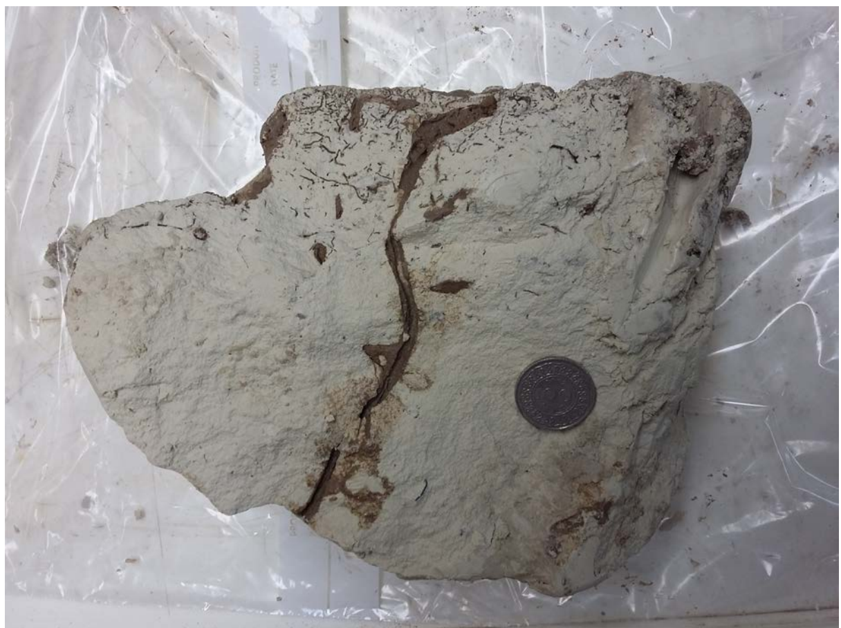
Figure 35: DRA-B2-3. En haut le sommet du banc encrouté et foré par deux types de terriers emplis de boue marron. Les terriers fins sont limités à la partie supérieure, les terriers larges traversent tout l'échantillon.
