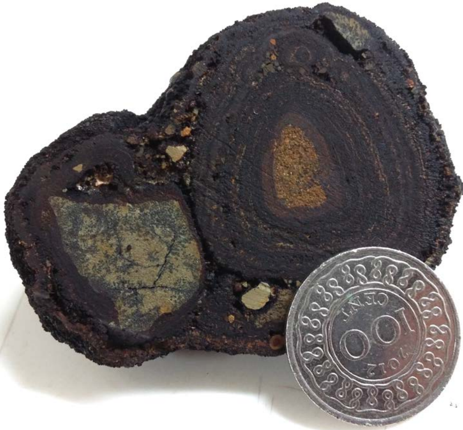
Figure 24: Section de l'échantillon DRA-G2-9. Nodule constitué de l'accrétion de deux nodules et de plusieurs fragments. Le cœur du nodule de droite est constitué d'un grès fin ; celui du nodule de gauche d'une argilite.
