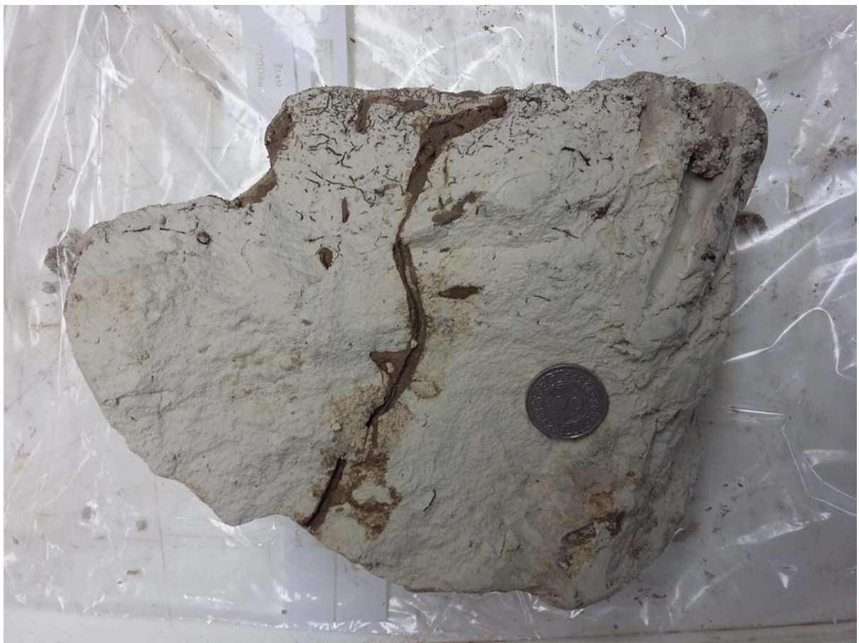
Figure 35: DRA-B2-3. En haut le sommet du banc encrouté et foré par deux types de terriers emplies de boue marron. Les terriers fins sont limités à la partie supérieure, les terriers larges traversent tout l'échantillon.
