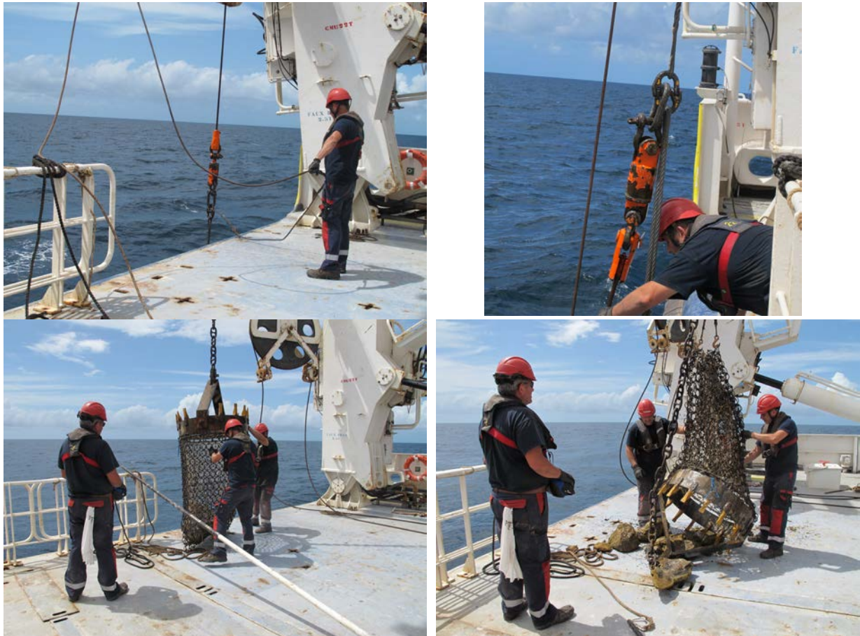
Figure 9: mise sur le pont de la drague A1. De gauche à droite et de haut en bas : 1- La drague est pendue au câble grand fond par l'émerillon (en rouge), le câble (qui pend) du treuil de manœuvre est fixé sous l'émerillon au câble martyr. 2- Reprise du câble martyr par le treuil de manœuvre, le câble grand fond et l'émerillon pendent et vont être détachés. 3- La drague est mise à bord, puis 4- retournée pour être vidée.
