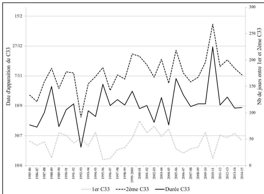
**Figure 6** – Dates d'apparition des valeurs de hauteur d'eau de l'Amazonas à Tamshiyacu correspondant au 33ème centile (4,5m) de la période 1985-2015, lors de la descente des eaux (1<sup>er</sup> C33) et lors de la remontée des eaux (2<sup>ème</sup> C33), et durée (en jours) entre ces deux dates.
