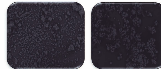
Figura 1: Microscopia Eletrônica de Varredura de leite em pó tradicional (à esquerda) e de leite em pó deslactosado (à direita) produzido por Spray Dryer piloto da LABMAQ, cujos parâmetros de secagem foram: Temperatura do ar de entrada: 160 °C, Temperatura do ar de saída: 74 °C ± 2,0 e Vazão do produto: 1,2 L/h
