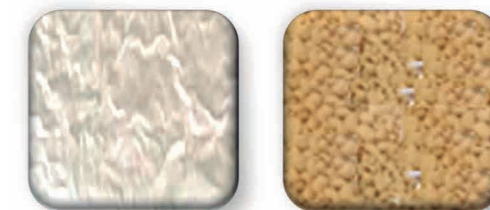
Figura 2: Coloração de leite em pó tradicional (à esquerda) e de leite em pó deslactosado (à direita) produzido por Spray Dryer piloto da LABMAQ, cuja condição empregada na secagem foi a condição de rotina para o produto clássico (leite em pó tradicional): Temperatura do ar de entrada: 160 °C, Temperatura do ar de saída: 74 °C ± 2,0 e Vazão do produto: 1,2 L/h
