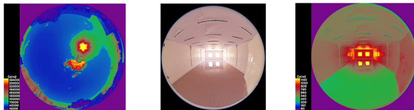
Figure 5. L'ambiance lumineuse intérieure du modèle équipé de Plafond anidolique à 10 h
