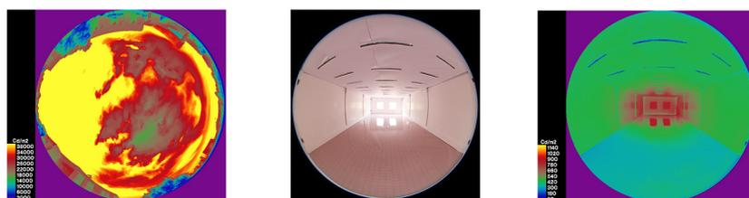
Figure 8. L'ambiance lumineuse intérieure du modèle équipé de Plafond anidolique à 16 h
