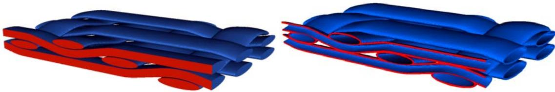
Figure 2 – Modèles volumiques du renfort tissé et de la matrice dans le cas d'un composite tissé à matrice céramique.
