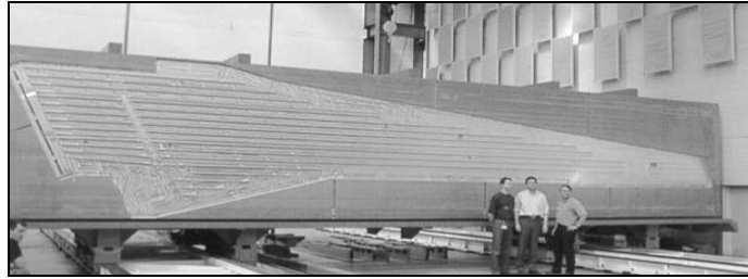
Figure 2 – Panneau extrados arrière F7X usiné à plat
