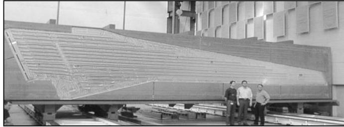
Figure 2 – Panneau extrados arrière F7X usiné à plat
