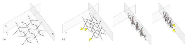
Fig. 4. Principe de pliage de grille Tensarch
