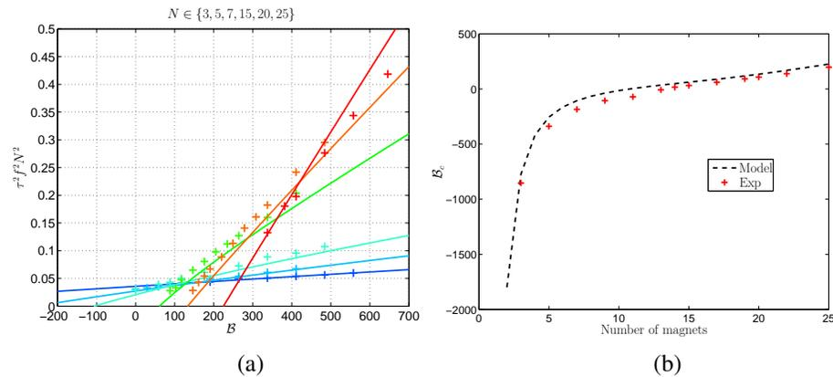
Figure 2: (a) : Comparaison des carrés de la première fréquence propre adimensionnée théorique (lignes continues) et expérimentale ('+') des chaînes de  $N$  aimants en fonction du champ magnétique adimensionné. Les couleurs, du bleu au rouge, correspondent respectivement à  $N = 3, 5, 7, 15, 20, 25$ . (b) : Champ critique de flambement de la chaîne pour différents  $N$
