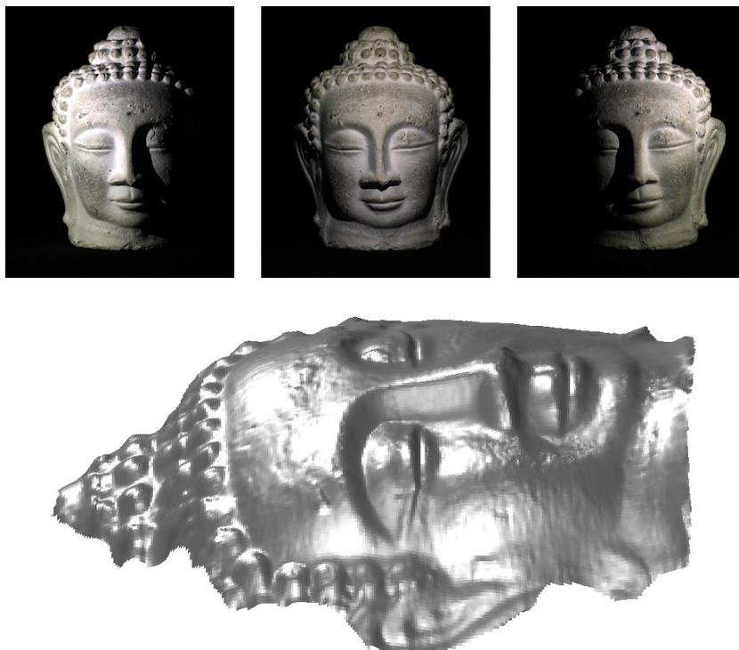
FIGURE 3. *Reconstruction 3D obtenue par stéréophotométrie avec sources ponctuelles. En haut : trois (parmi  $m = 8$ ) images RVB d'une statuette en plâtre, éclairée par  $m = 8$  LEDs. En bas : résultat de l'approche variationnelle proposée.*
