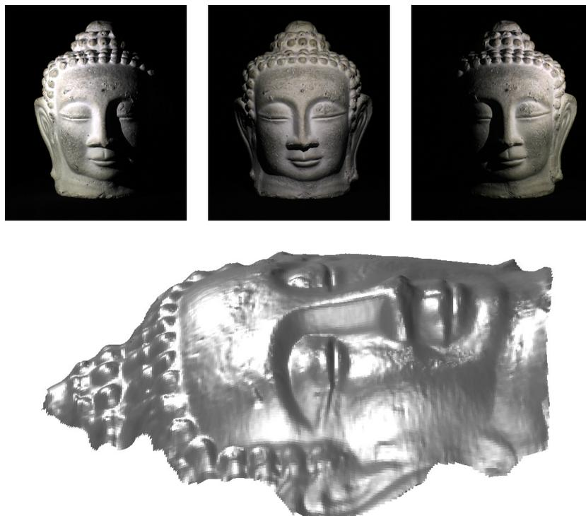
FIGURE 3. *Reconstruction 3D obtenue par stéréophotométrie à sources ponctuelles. En haut : trois (parmi  $m = 8$ ) images RVB d'une statuette en plâtre, éclairée par  $m = 8$  LEDs. En bas : résultat de l'approche variationnelle proposée.*
