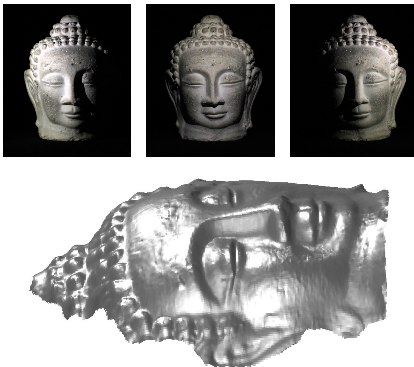
FIGURE 3. Reconstruction 3D obtenue par stéréophotométrie avec sources ponctuelles. En haut : trois (parmi m = 8 ) images RVB d'une statuette en plâtre, éclairée par m = 8 LEDs. En bas : résultat de l'approche variationnelle proposée.
