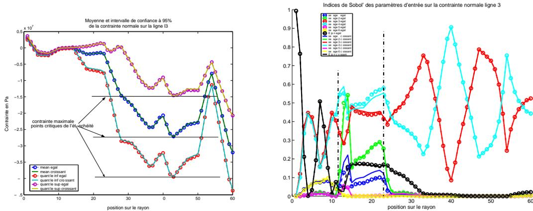
Figure 5 – Gauche : Evolution de la moyenne et de l'intervalle de confiance à 95% des contraintes normales le long de la ligne #3 - Droite : Evolution des indices de sobol' le long de la ligne #3
