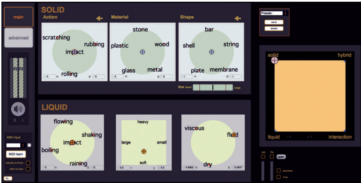
Espace de navigation sonore issue du paradigme {action/objet}. La partie supérieure permet la construction de sons « solides » à partir de l'ajustement continu de la matière, la forme et la taille de l'objet virtuel, puis de l'action effectuée sur ce dernier. La partie inférieure permet la construction de sons liquides par ajustement du débit, de la pression, de la viscosité du liquide et du type d'écoulement. La partie de droite contrôle l'hybridation des invariants morphologiques. Elle permet ainsi des transitions continues entre des interactions naturelles (liquide tombant sur un solide) et imaginaires (écoulement d'objets métalliques).
