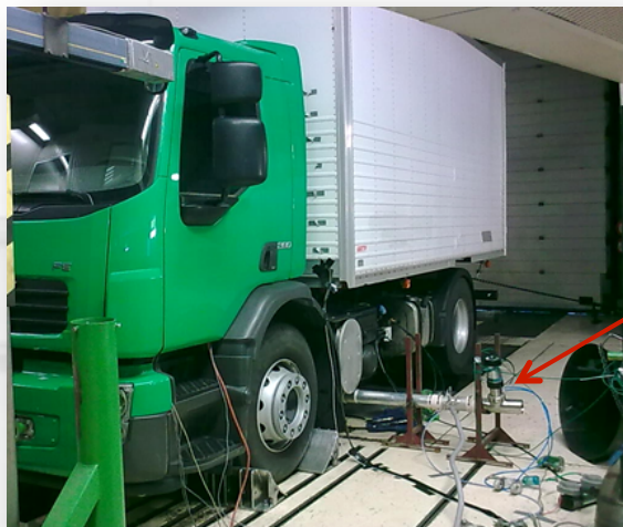
Capteurs de pression (Pitot), sondes de prélèvement des gaz et analyseur des particules (concentration massique)
