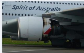
Figure: Explosion du réacteur
