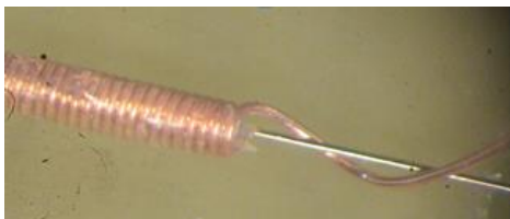
Figure 1. Elément sensible GMI-bobine
