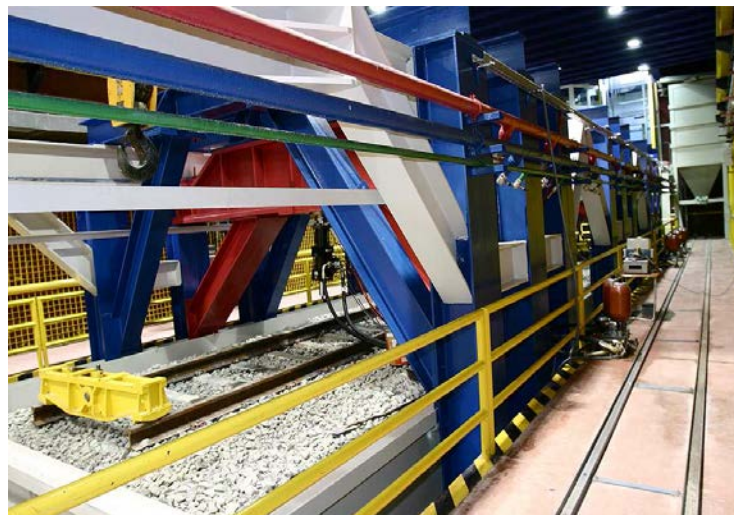
Figure 6 : Banc d'essai à l'échelle 1 de structures de voie ballastée (CEDEX-Madrid)
