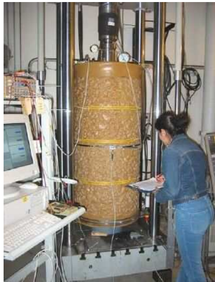
Figure 5 : essais triaxiaux sur du ballast échelle 1 (NGI-Norvège)
