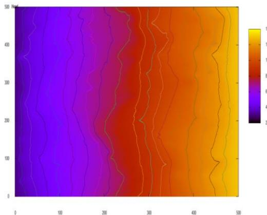
**Figure 3.** Maquette numérique d'écoulement dans un domaine poreux contenant un système statistique de 200 fractures (cf. Fig. 2) : carte de couleur et iso-valeurs du champ de charge hydraulique  $H(x,y)$  dans le système matrice/fractures, avec un contraste de conductivité  $K_f/K_m=1000$ . (collaboration stagiaire M. Babraoui 2015).
