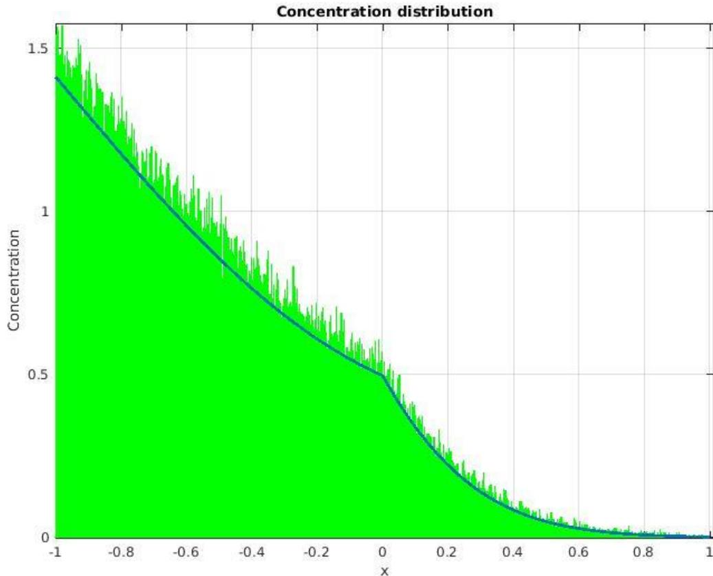
Figure 1: Comparaison de deux résultats, analytique (EDP) et numérique (Particules), pour un problème 1D avec conditions limites de Dirichlet (concentration fixée  $C = 1.4$  à gauche, et  $C = 0$  à droite). Le coefficient de diffusion  $D(x)$  est discontinu en  $x=0$ . La courbe en trait plein montre la solution analytique de l'EDP de diffusion, et l'histogramme en vert montre le résultat de l'approche particulaire avec  $N=300\ 000$  particules, en utilisant la méthode 3.
