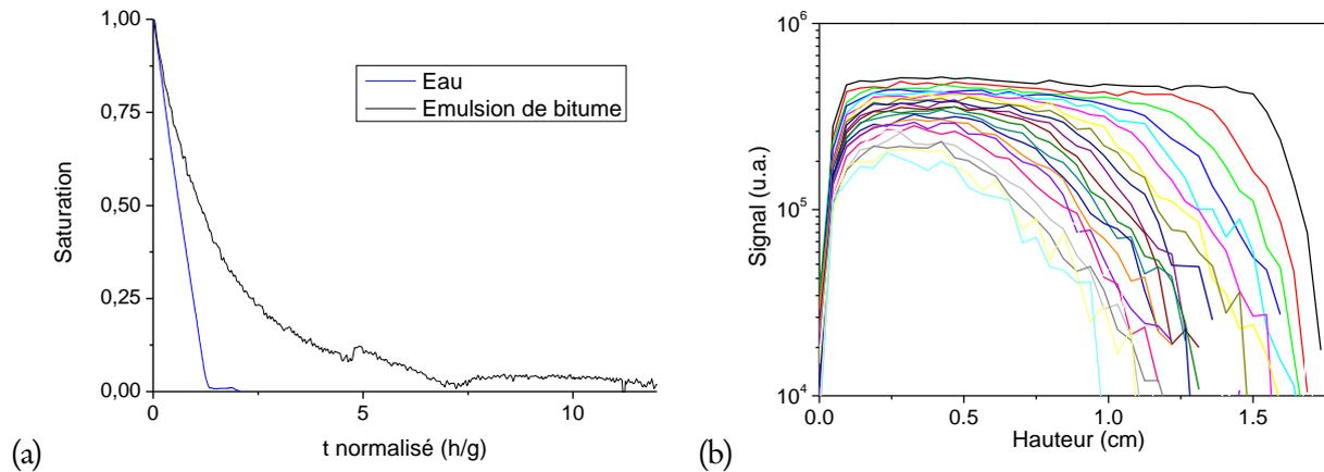
Figure 1: Courbe de séchage (a) et profils de saturation suivant la hauteur (b) d'un milieu poreux modèle initialement saturé en émulsion de bitume au cours du séchage (1profil/8h)
